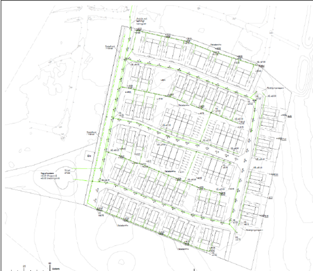
Figur 10: Föreslagen princip för dagvattenhantering och bedömda flödesriktningar. Bild: AFRY, 2023-04-03.
