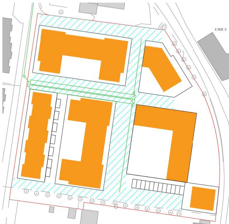
Figur 27: Kartan visar ett exempel på hur dagvatten kan fördröjas inom fastigheten. De gröna linjerna visar ledningar och avsättningsmagasin under mark. Den blå skrafferingen visar område där man kan placera växtbäddar. Växtbäddar kan med fördel även placeras på innergårdarna.
